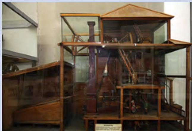
Модель центральной воздуходувной установки с первым в мире универсальным тепловым двигателем
